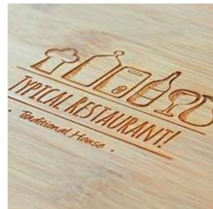
Uso de un rayo láser de alta precisión, que permite realizar grabados en bajo relieve. Este láser puede ser de fibra óptica, apto para metales, de CO2, apto para madera y corcho, o UV, apto para vidrio.
