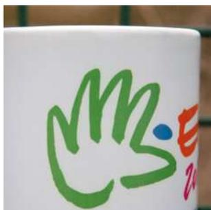
Impresión en papel especial del logo mediante una impresora que utiliza tintas de sublimación. La transferencia de tinta al producto se realiza mediante presión y calor.
